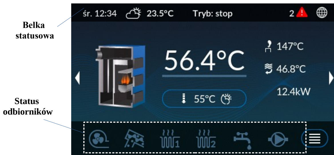
Ilustracja 16: Ekran główny, ekran kotła C.O.
